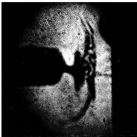
Рис. 4. След пучка быстрых электронов, уходящих в приосевой области разряда из области пинчевания
