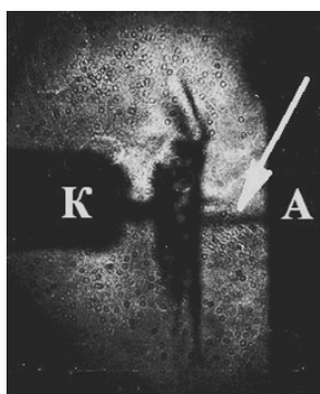
Рис. 1. Тенеграмма разряда: К — катод; А — анод (стрелкой отмечен канал оптически плотной среды, тянущийся от области пинчевания к поверхности внешнего электрода)
