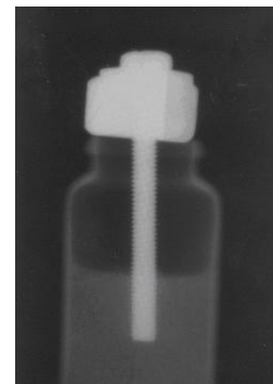
Рис. 5. Фотография стеклянного флакона с металлическими предметами и водой, снятая в рентгеновском потоке на пленке в кассете между двумя люминесцентными экранами
