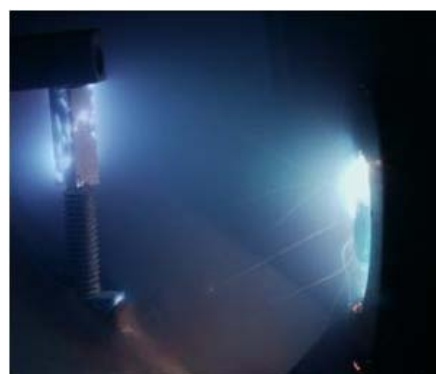
Рис. 4. Фотография микроплазменных разрядов на образце (слева) при воздействии плазменного потока из инжектора (справа). Диаметр инжектора 30 мм
