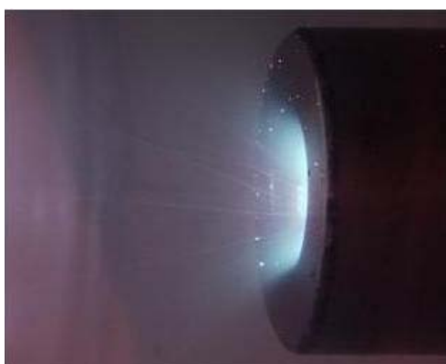
Рис. 2. Фотография свечения плазменного потока из инжектора в видимом диапазоне длин волн (справа — плазменный инжектор диаметром 30 мм)
