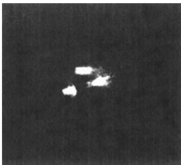
Рис. 3. Рентгеновская обскураграмма плазмы микропинчового разряда
