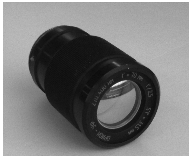
Рис. 3. Внешний вид изготовленного УФ-объектива
