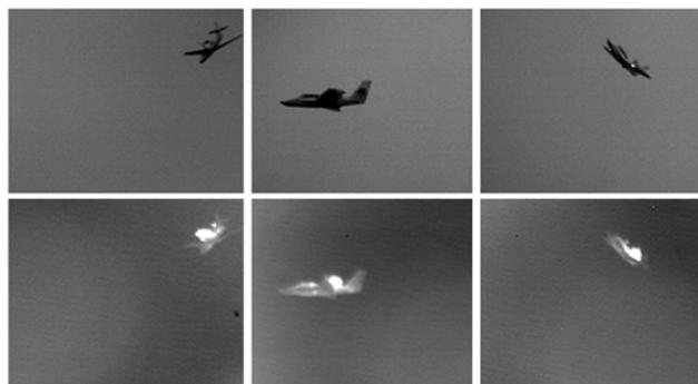
Рис. 2. Регистрация изображений самолета теплотелевизионной системой: ТВ-канал сверху, ИК-канал снизу
