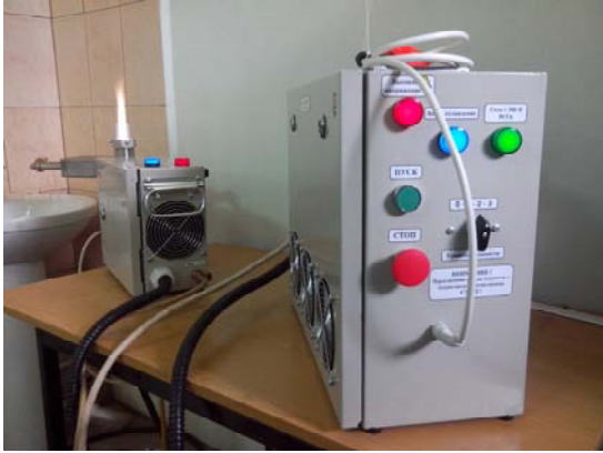
Рис. 3. Микроволновый плазмотрон, работающий на атмосферном давлении, расход воздуха 20—30 л/мин
