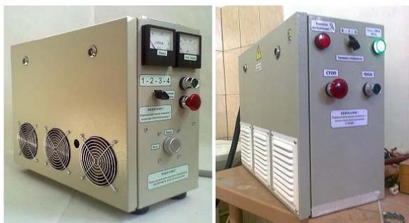
Рис. 1. Источники питания магнетронных генераторов: слева — с независимым регулированием тока накала и индикацией величины анодного тока; справа — в максимально «бюджетном» исполнении
