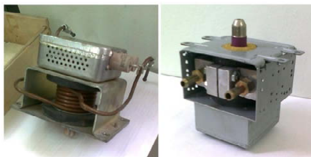
Рис. 2. Варианты модификации серийных магнетронов для работы с водяным охлаждением при повышенных уровнях генерируемой мощности
