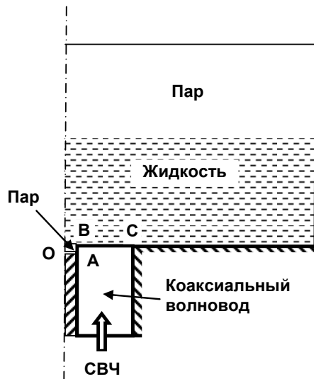
Рис. 1. Область расчета и распределение жидкой и паровой фаз n -гептана в начальный момент времени. Участок ABC проницаем для СВЧ-волны и непроницаем для n -гептана. |OA| = 1,5 мм (радиус центрального проводника коаксиального волновода), |AB| = 1 мм, |BC| = 6 мм.
