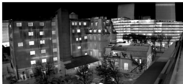
Рис. 1. Городской пейзаж, полученный ИК ФПУ на основе QWIP-структур формата 640x512 элементов длинноволнового диапазона спектра, T = 75 К, шаг 25 мкм, NETD = 30 мК (фирма Thales).
