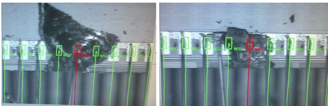
Рис. 1. Ненадежность разваренных контактов кристалла из-за сколов после дисковой алмазной резки.
