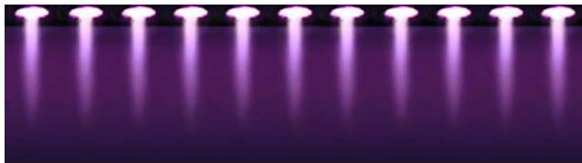
Рис. 1. Внешний вид множественных плазменных струй, генерируемых ДБР в потоке воздуха. 11 струй свободно выдуваются в окружающий воздух. Суммарная мощность разряда P = 825 Вт. Скорость плазменной струи на выходе из каждой трубки составляет V = 30 м/с.
