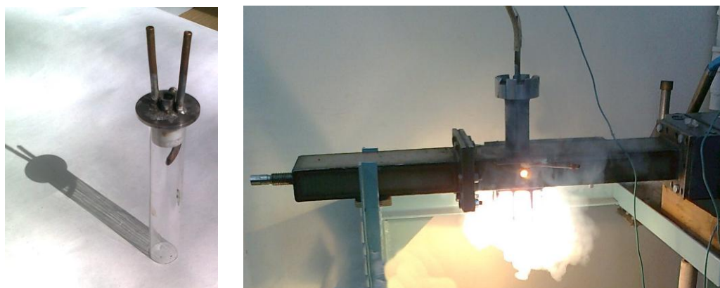
Рис. 3. Простой универсальный завихритель в процессе введения вольфрамового стержня в плазму водяного пара.
