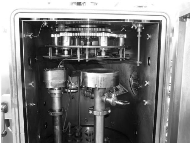
Рис. 1. Технологическая вакуумная камера экспериментальной установки.
