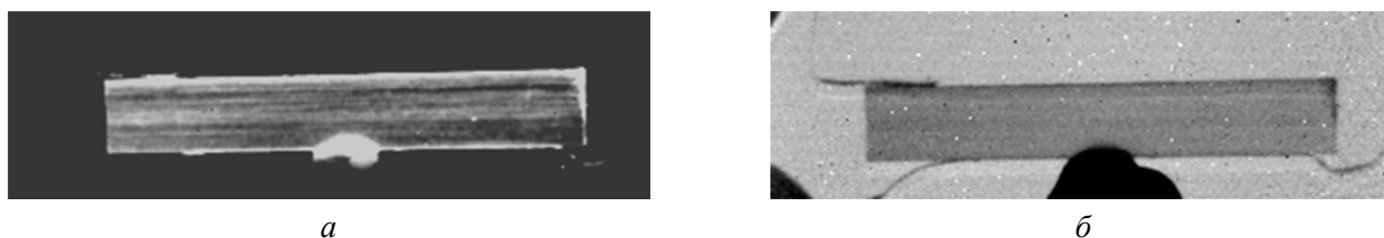
Рис. 5. Тепловизионные изображения высоковольтного ФЭП при прямом (а) и обратном (б) напряжениях смещения.
