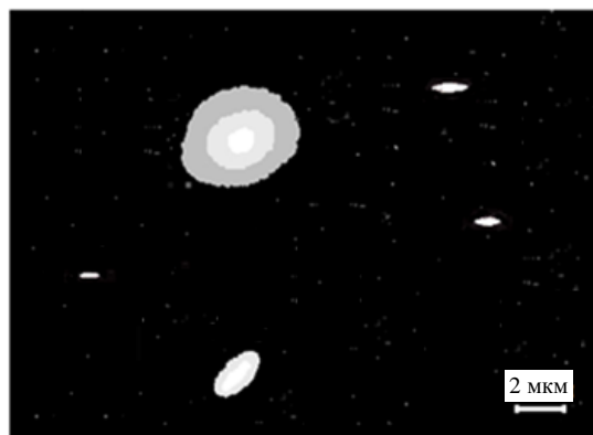
Рис. 1. Снимок примесных микровключений никеля в образцах n -Si<Ni>, с v_{\text{охл}} = 1 град/с.
