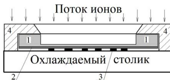
Рис. 2. Схема, иллюстрирующая процесс формирования рентгенопрозрачных окон посредством плазмохимического травления, где кремниевая подложка – 1 с напыленными слоями – 2 и сформированной из золота топологией – 3 располагается на охлаждаемом столике в посадочном месте дюралюминиевого трафарета – 4.
