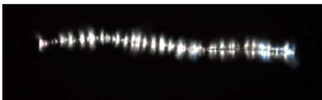
Рис. 2. Интегральная фотография электровзрыва сборки.
