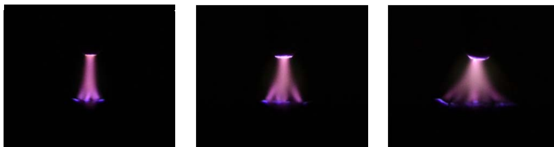
Рис. 2. Разряд с жидким катодом. Раствор HNO_3 с электропроводностью 300 мкСм/см и pH=3,1 . Расстояние между электродом и поверхностью жидкости 2 мм. Ток разряда 20, 40 и 80 мА соответственно
