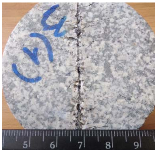
Рис. 1. Образец гранодиорита после лазерной дезинтеграции
