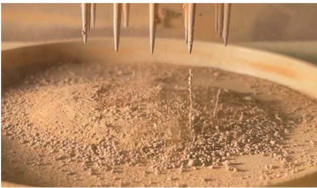
Рис. 3. Появление длинных неустойчивых столбиков над глиняным порошком под воздействием отрицательного коронного разряда. Напряжение 16 кВ
