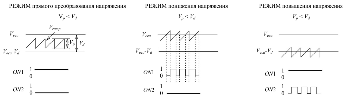
Рис. 2. Логика управления преобразователем при размахе пилообразного сигнала V_p меньше напряжения V_d
