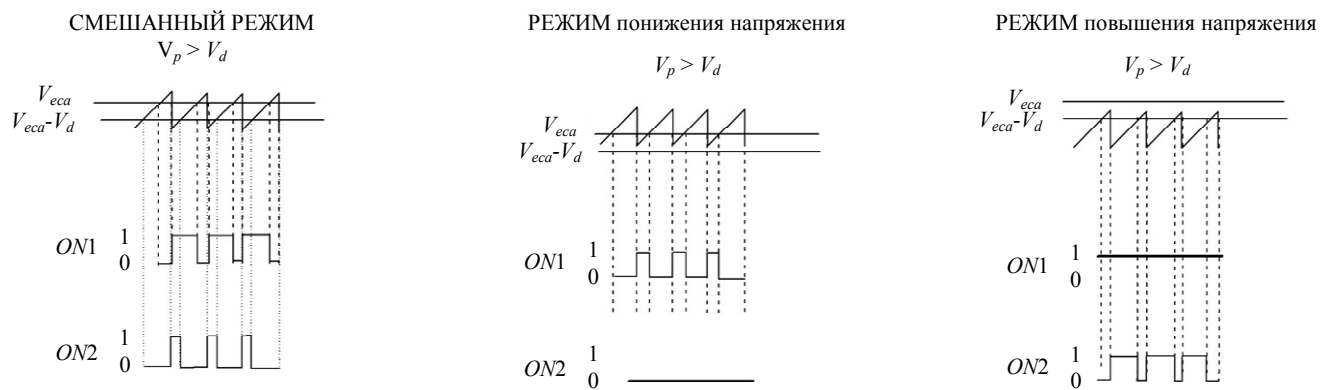
Рис. 3. Логика управления преобразователем при размахе пилообразного сигнала V_p больше напряжения V_d
