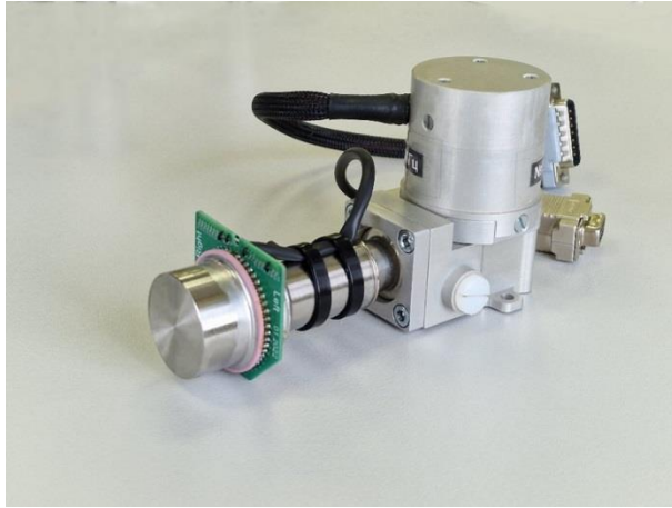
Рис 1. Внешний вид имитаторов тепловой нагрузки АО «НПО «Орион» (имитатор состыкован с МКС Крюо 1000)
