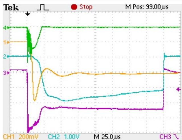
Рис. 2. Осциллограммы токов и напряжения разрядов: CH4 – ток поджигающего разряда (5 А/дел); CH1 – ток вакуумно-дугового разряда (20 А/дел); CH2 – ток магнетронного разряда (10 А/дел); CH3 – напряжение магнетронного разряда (200 В/дел)
