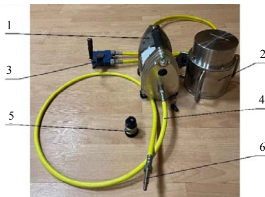
Рис. 1. Рабочий комплект шлангового гамма-дефектоскопа «РИД 50W» класса «Р»: 1 – головка радиационная (РГ); 2 – контейнер транспортно-перезарядный; 3 – механизм перемещения; 4 – ампулопровод; 5 – коллиматор; 6 – наконечник
