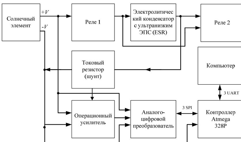
Рис. 2. Структурная схема экспериментального устройства для измерения вольт-амперных характеристик солнечных элементов
