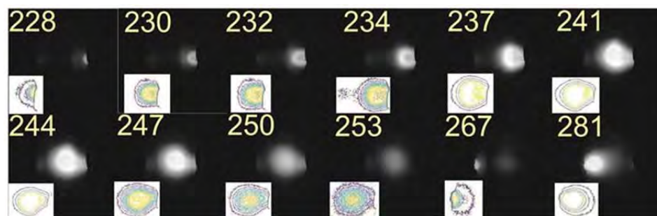
Рис. 4. Режим диффузного (плазменный шлейф) разряда, расход смеси водород H_2 0,08 г/с и метан CH_4 0,01 г/с, ток 6 А, мощность 7 кВт
